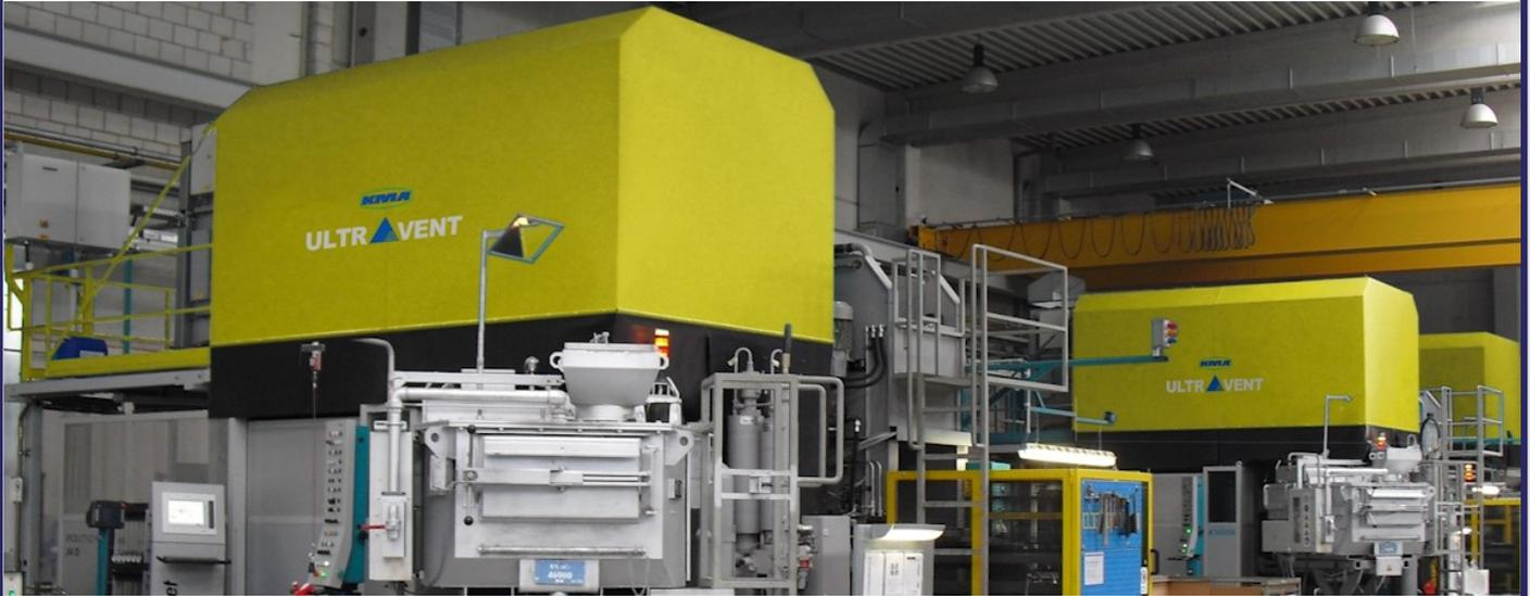
현재 공기 정화 시스템에서 에너지를 가장 효율적으로 절약하는 시스템은 KMA 독립 필터 시스템을 통한 공기 재순환 시스템입니다. 각각의 다이캐스팅 기기는 KMA 공기 정화 시스템인 배기 후드와 공기정화필터가 장착 되어있습니다. KMA 공기 정화 시스템은 데미스터 필터, 정전기식 필터 및 자동 필터 세척 시스템으로 구성되어 있습니다.
